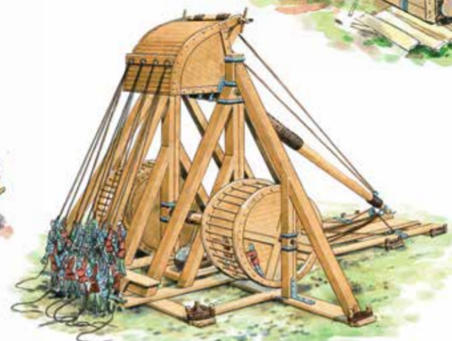
Machina miotająca z przeciwwagą poruszana przez ludzi. Wurfmaschine mit von Menschen bewegtem Gegengewicht. Throwing machine with counterbalance operated by people.
