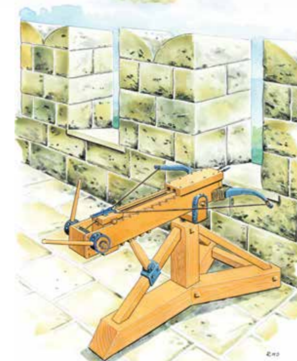
Kusza wałowa do miotania strzał. Wallarmbrust zum Abschießen von Pfeilen. Arrow throwing ballista.
